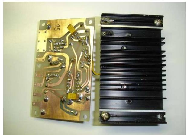
Bild 4.2.3: bestückte Platine, Leiterseite
