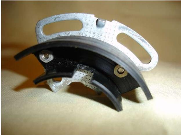
Bild 4.1.3: Gehäuse auf leicht modifizierter Unterbrechergrundplatte
