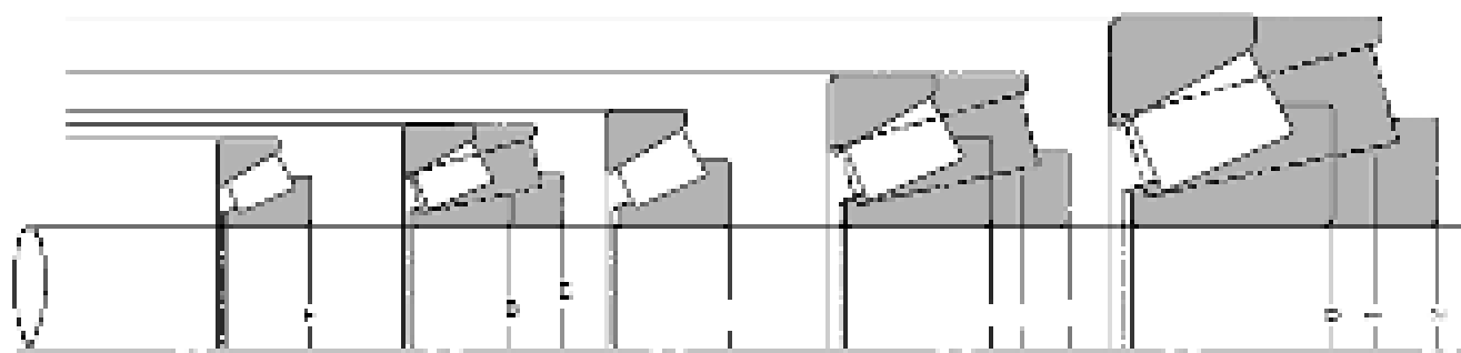
3.6 Ábra Kúpújszállós csapágyak méreteinek összehasonlításán
