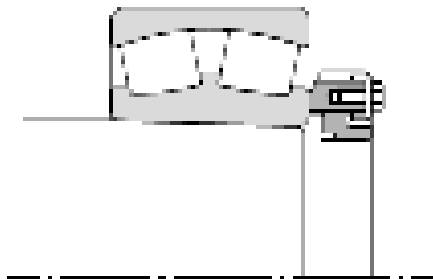
14.7 Ábra Osztott menetes gyűrűvel történő rögzítés
